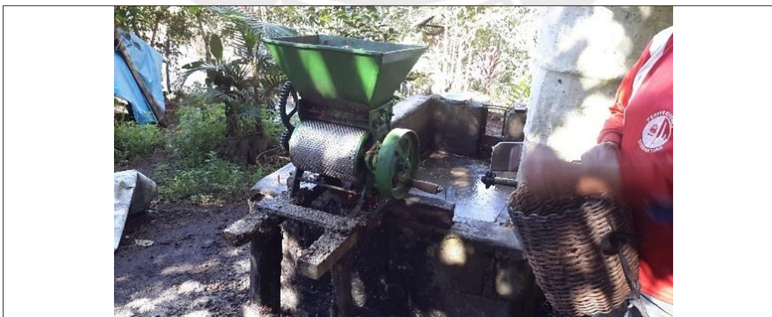
Figura E3: Despulpadora manual de café
